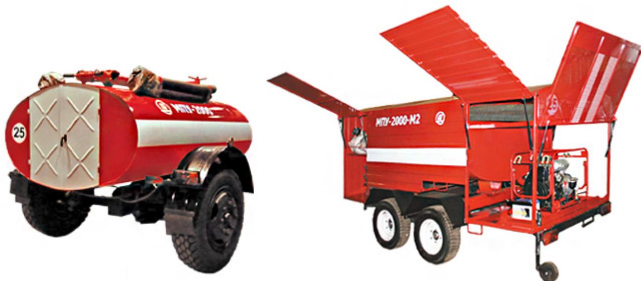
Мобильные пожарные установки МПУ-2000, МПУ-2000-М2 используются в качестве привлеченного мобильного агрегата для самозащиты населения от пожаров и оснащения добровольных пожарных дружин при тушении возгораний травы, лесных пожаров, а также подачи первого ствола для локализации и тушения пожаров в сельских населенных пунктах до прибытия подразделений ГПС.
