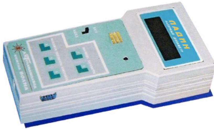
Лазерный дозиметр предназначен для измерения параметров отраженного и рассеянного лазерного излучения с целью оценки степени опасности излучения для организма человека.
